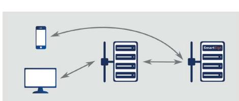
SmartSign utilise le principe d'authentification « Out-Of-Band » (OOB) qui assure la sécurisation en dehors du canal serveur web navigateur. Il établit un second canal de communication sécurisé avec les serveurs SmartSign, assurant ainsi une protection contre les éventuelles brèches de sécurité liées à la connexion du navigateur de l'utilisateur, dans le cas où une interception serait réalisée.
